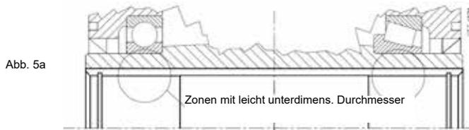
Zur Demontage der langsamlaufenden Hohlwelle der Stirnrad- und Kegelstirnradgetriebe (erster Arbeitsvorgang beim Getriebeausbau) die Passfeder nut gem. Abb. 5 zur Zwischenwelle ausrichten und die Welle an der Seite der Bezugsrille schieben (Kreisnut auf Wellenabsatz).
