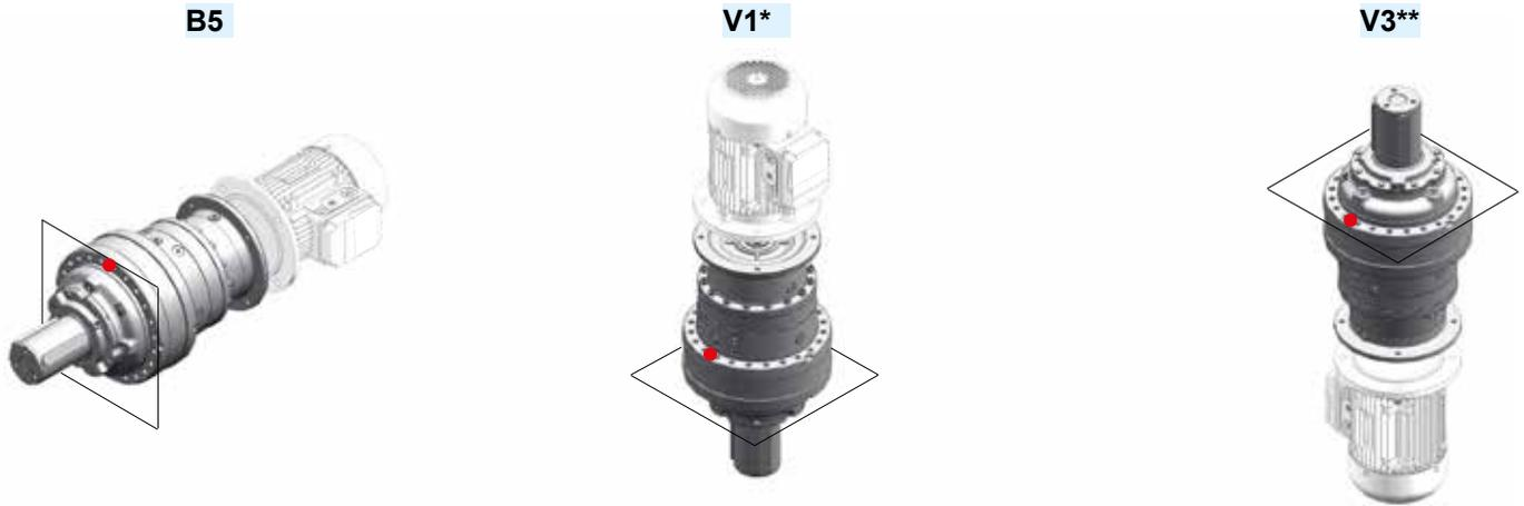
\*Je nach Größe des Motors ist ein Ausgleichsbehälter erforderlich (s. Kap. 6 des EP-Kat.).
