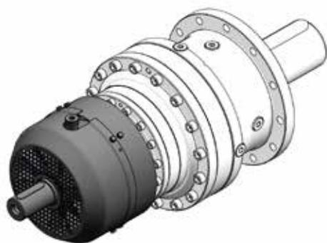
Quand le réducteur est équipé avec ventilateur, il faut vérifier que un adéquat espace pour l'aspiration de l'aire du refroidissement reste, même après avoir monté la protection.
