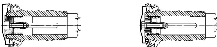
Utilizzando gli **anelli di bloccaggio** (grand. 40 ... 63, fig. 5.9.1) o la **bussola di bloccaggio** (grand. 64 ... 360, fig. 5.9.2) si possono avere un montaggio e uno smontaggio più facili e precisi e l'eliminazione del gioco tra linguetta e relativa cava; sistema ad attrito compatibile con esecuzione ATEX.
