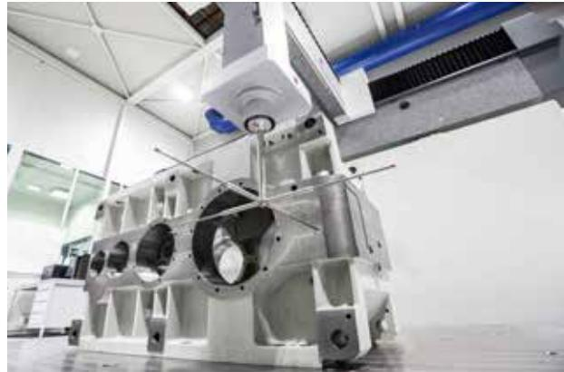
Aus Sphäroguss (UNI ISO 1083) gefertigte, horizontal geteilte Getriebehälften mit verstärkten Versteifungsrippen
