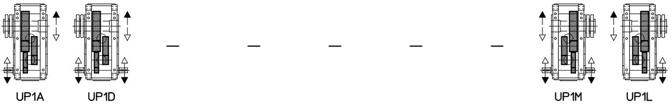
Langsamlaufende Hohlwelle mit Spannsatz auf Maschinenseite (auf Anfrage)
